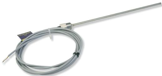
Датчики замерзания (TMI) используются для измерения температуры жидкости в системах воздушного кондиционирования и обратной воды сети теплоснабжения. В составе датчика TMI предусмотрена погружная трубка диаметром 4 мм и длиной 170 мм.
